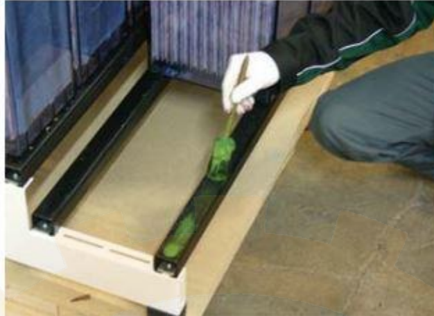
تصویر (۲-۴) پرب کردن سطح ساپورت‌ها با استفاده از روغن
