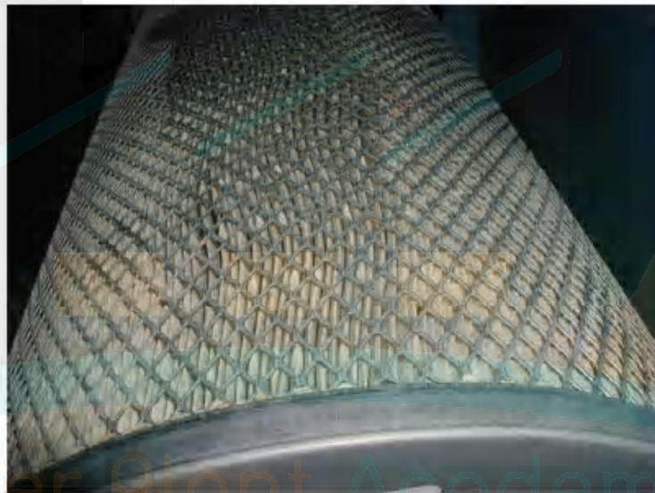
شکل ۲۰: چگونگی نفوذ آب درون فیلترهای هوایی. انحراف شیارهای فیلتر فشنگی
